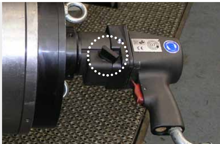
alkitronic® CLS2 , atornillador de 2 velocidades. Palanca de cambio a marcha rápida o de potencia.
