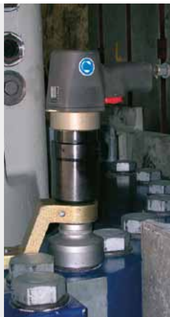
alkitronic® CLD CLD atornilladores en el trabajo (fotos a la derecha). Uniones roscadas en una brida con tuercas así como en un motor.
